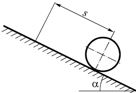
Вращающийся с угловой скоростью  $\omega_0$  сплошной однородный цилиндр радиуса  $r$  ставится на наклонную плоскость, составляющую угол  $\alpha$  с горизонтом, и начинает вкатываться вверх. Начальная скорость его центра при этом равна нулю. Коэффициент трения между цилиндром и плоскостью равен  $f$ . Определить, на какое максимальное расстояние  $s$  поднимется центр цилиндра вдоль наклонной плоскости.
