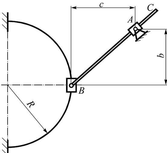
Ползун  $B$  перемещается по дуге окружности радиуса  $R$ . В изображенном на рисунке положении механизма ускорение точки  $B$  направлено вдоль прямой  $BC$  и равно  $a$ . Найти для этого положения скорость и ускорение точки  $C$ , если заданы размеры  $b$ ,  $c$ , а также  $BC = l$ .
