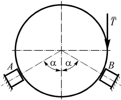
Однородный цилиндр веса  $G$  лежит на двух симметрично расположенных относительно вертикали опорах  $A$  и  $B$ , положение которых определяется углами  $\alpha$ . Коэффициент трения между цилиндром и опорами равен  $f$ . Найти минимальное значение силы  $T$ , которую необходимо приложить, чтобы вывести цилиндр из равновесия.
