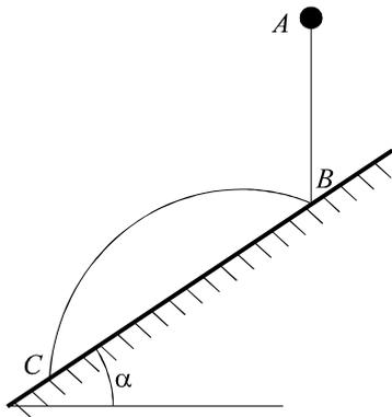
Шарик падает из положения  $A$  без начальной скорости на наклонную плоскость, составляющую угол  $\alpha$  с горизонтом. Отразившись в точке  $B$ , он затем попадает в такую точку  $C$ , что  $BC = l$ . Считая удар абсолютно упругим и пренебрегая сопротивлением воздуха, определить время движения шарика на участке  $AB$ .
