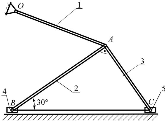
Конструкция, расположенная в вертикальной плоскости, состоит из трех однородных стержней 1, 2, и 3 одинаковой массы, соединенных шарнирно в точке  $A$ , и невесомых ползунов 4 и 5, связанных нерастяжимой нитью. Определить отношение наибольшей из трех сил, действующих со стороны стержней на шарнир  $A$ , к наименьшей аналогичной силе.
