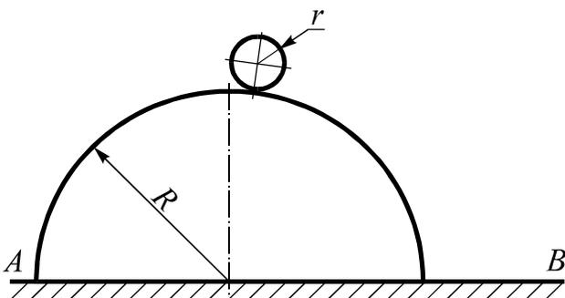
Однородный цилиндр радиуса  $r$  начинает с ничтожно малой начальной скоростью скатываться из наивысшего положения с неподвижного полуцилиндра радиуса  $R = 6r$ . Качение цилиндра происходит без проскальзывания. Какую скорость непосредственно перед ударом будет иметь точка цилиндра, которая первой коснется плоскости  $AB$ .
