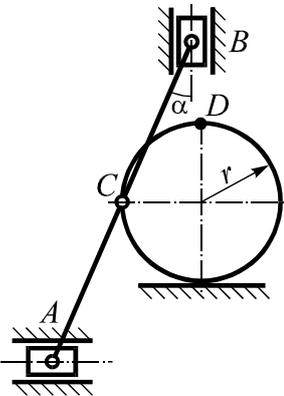
Точка  $A$  шатуна  $AB$  длиной  $2l$  имеет в данный момент времени скорость  $v_A$  и равное нулю ускорение. При этом шатун составляет угол  $\alpha$  с вертикалью. Своей центральной точкой  $C$  шатун шарнирно соединен с диском, который в процессе движения механизма постоянно касается горизонтальной плоскости. Принимая радиус диска равным  $r$ , определить скорость и ускорение его верхней точки  $D$ .
