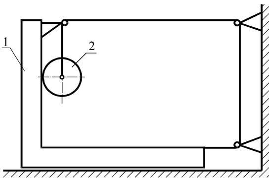
Платформа 1 массы  $m_1$  скользит по гладкому горизонтальному полу. По ее вертикальной направляющей катится однородный диск 2 массы  $m_2$ . Платформа и диск соединены невесомой канатно-блочной системой, причем трение между канатом и блоками отсутствует. Найти минимальное значение коэффициента трения между диском и платформой, при котором качение происходит без проскальзывания.
