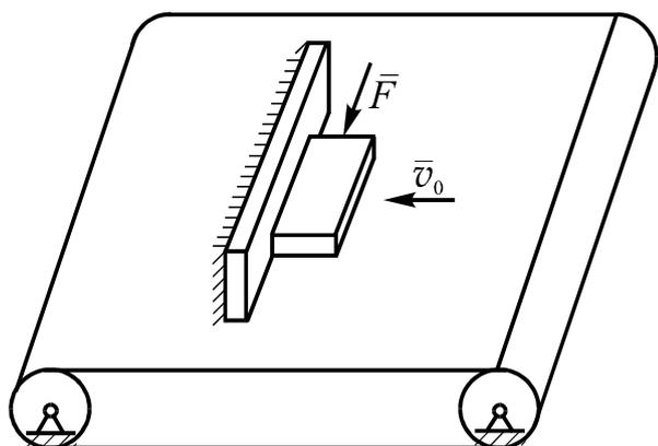
Груз массой  $m$ , находящийся на ленте транспортера, движется в поперечном направлении под действием постоянной силы  $F$ . Движению груза в продольном направлении препятствует неподвижная преграда.
