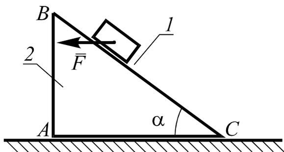
Груз 1 массы  $m_1$  скользит по боковой грани призмы 2 массы  $m_2$ , перемещающейся по горизонтальной плоскости. Трение между телами отсутствует. Угол  $\alpha$  известен. Найти минимальное значение горизонтальной силы  $F$ , при котором начнется опрокидывание призмы (т. е. произойдет отрыв точки  $C$  от плоскости).
