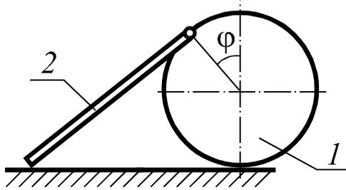
Однородный диск массой  $m_1$  и радиусом  $R$  шарнирно соединен с однородным стержнем массой  $m_2$  и длиной  $l$ . Определить минимальное значение коэффициента трения сцепления между телами и поверхностью, при котором система будет находиться в равновесии в положении, определяемом углом  $\varphi$ .
