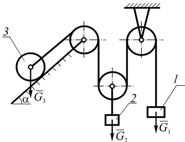
Чему должен быть равен вес груза 1  $G_1$ , чтобы этот груз был неподвижным в механической системе, в которой  $G_2 = 3G$ ,  $G_3 = G$ . Массами необозначенных цифрами блоков, нитей и трением в шарнирах пренебречь. Считать тело 3 сплошным однородным диском. Коэффициент трения между диском 3 и поверхностью равен  $f$ . Значение угла  $\alpha$  задано.
