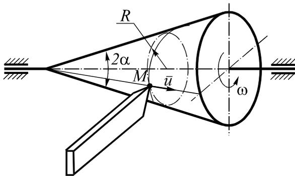
Резец движется поступательно вдоль поверхности конуса с постоянной скоростью  $\bar{u}$ . Определить радиус кривизны траектории точки  $M$  реза относительно конуса в том месте, где его радиус равен  $R$ , если конус вращается равномерно с угловой скоростью  $\omega$  вокруг неподвижной оси и угол при вершине конуса равен  $2\alpha$ .
