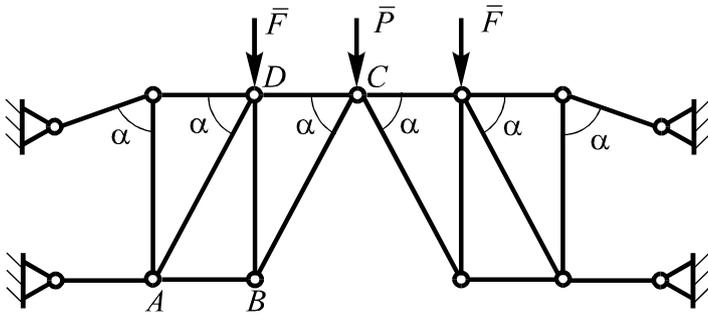
В изображенной на рисунке стержневой конструкции все стержни невесомые. Найти, при каком соотношении между силами  $F$  и  $P$  внутренние силы в стержнях  $AB$  и  $CD$  будут отличаться в 5 раз.  $\alpha = 60^\circ$ .
